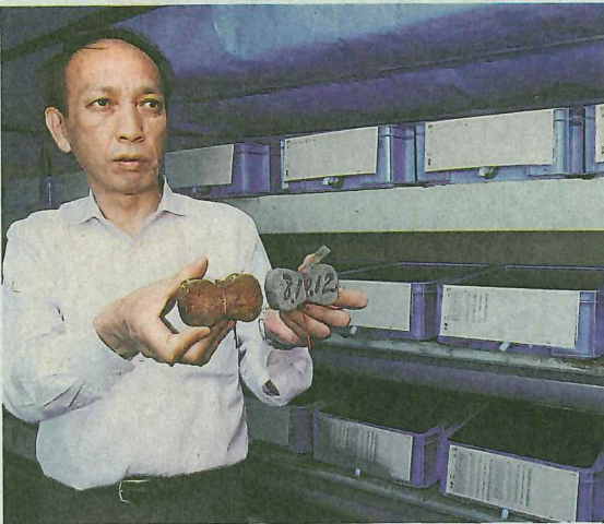
④テストピースを手にする小樽港事務所の矢野所長。ひょうたん型のテストピースは海水に浸すなど条件を変えて保管庫で80年以上も保存している⑤「みなとの資料コーナー」には広井が作った耐久試験用の機械も展示されている。見字は無料(土・日曜と祝日は休館) 小樽市築港
